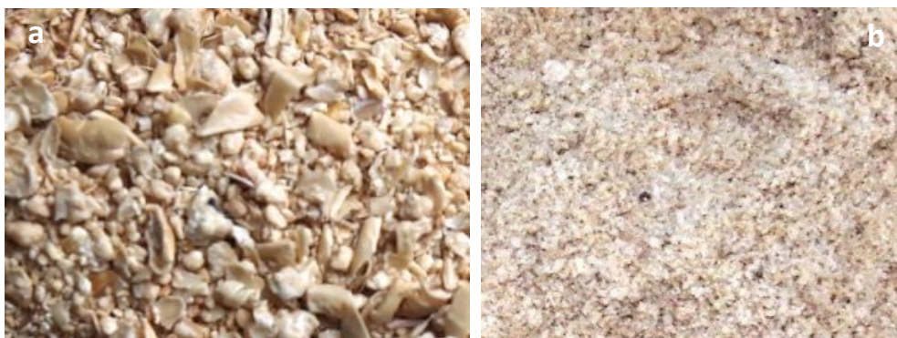
Figure N° 2 : Exemple de broyage. a: Mouture insuffisante, b: Mouture satisfaisante
